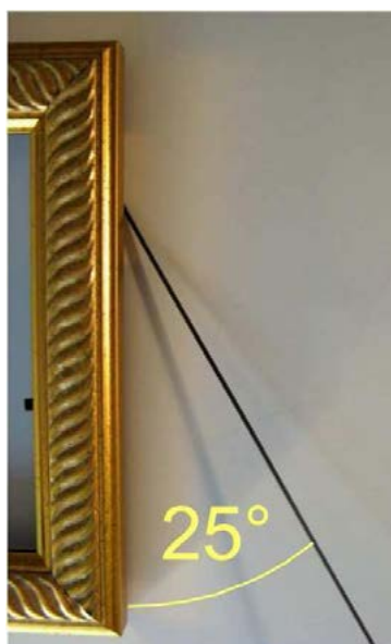
Angle d'inclinaison du micro tournevis pour régler les vis basse et haute
