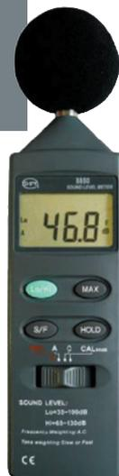
Conçu pour répondre aux exigences du terrain, cet appareil possède une calibration par potentiomètre. Il permet une sortie analogique en tension AC/DC pour analyser les bruits, enregistrer des signaux, oscilloscope, etc. Mémoire les valeurs hold et la valeur maxi. Fourni avec bonne micro, mode d'emploi et housse de protection.
