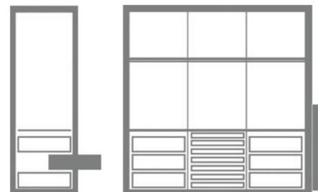
Les tiroirs sont réalisés en tôle d'acier galvanisée et peinte, en une seule pièce, pressés à froid sans aucune soudure. A l'intérieur du corps du tiroir, il y a des fentes verticales et horizontales pour l'application d'éventuels séparateurs internes.
