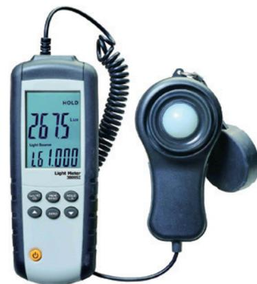
Le luxmètre numérique permet la mesure de la force d'éclairage et de la luminosité des lampes à incandescence classiques et des éclairages à LED. Les valeurs mesurées sont affichées clairement sur le grand écran à cristaux liquides. Le capteur de lumière est séparé de l'appareil de lecture, pour une orientation précise vers la source de lumière.
