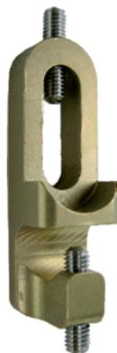
Ce crochet mural en **laiton massif** est réglable en hauteur et antivol. Il est compatible avec la plupart des attaches de cadres ( attaches D, pitons à œil, cordes, câbles, etc.) jusqu'au fil de Ø 5 mm. Il se fixe au mur par une vis, possède un **réglage de niveau** et une **vis de blocage** qui empêche l'attache du cadre de se retirer du système.
